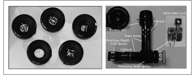
図2 符号化開口の実装例 (左：フォトマスク、右：LCoS)
